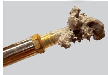
**Tipp:** Wenn Sie die maximale Ausbeute aus der Schaumdose und ein perfektes Schaumbild erhalten möchten, muss der PU-Schaum und der Untergrund befeuchtet (nicht bewässert) werden, dann kann der Schaum erst sauber expandieren. Da die Fensterprofile immer dicker werden, ist es ratsam von innen und außen zu schäumen oder auf zweimal von einer Seite, da der Schaum beim einmal Auftrag zu wenig Luftfeuchtigkeit bekommt und sich dadurch Löcher im Schaumbild bilden können.
